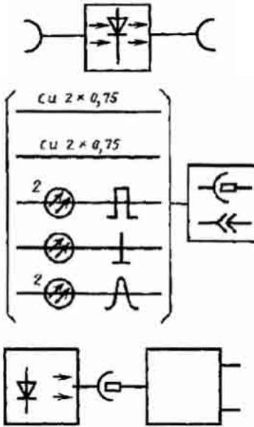
7. Передающий оптоэлектронный модуль со светодиодом с оптическим ответвителем
