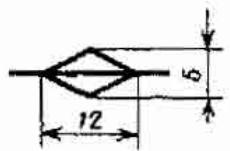
7. Соединитель оптический комбинированный
