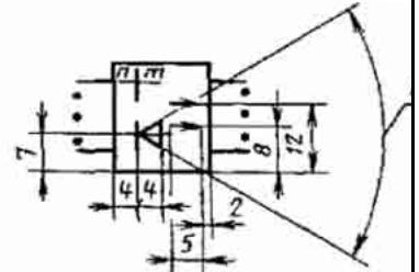
10. Оптоэлектронный передающий модуль со светодиодом
