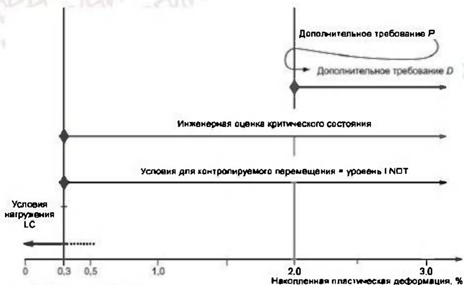
Рисунок 15.4 — Иллюстрация случаев необходимости требований U и D , а также уровня 1 NDT
